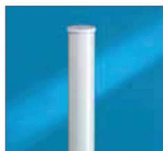
Les panneaux sont à installer avec : Poteaux ronds diamètre 48 x 1,50 mm avec capuchon, galvanisés et plastifiés blanc RAL 9010. La fixation des panneaux aux poteaux se fait grâce à des colliers spéciaux (Bekazur 2D) qui sont en polyamide.
